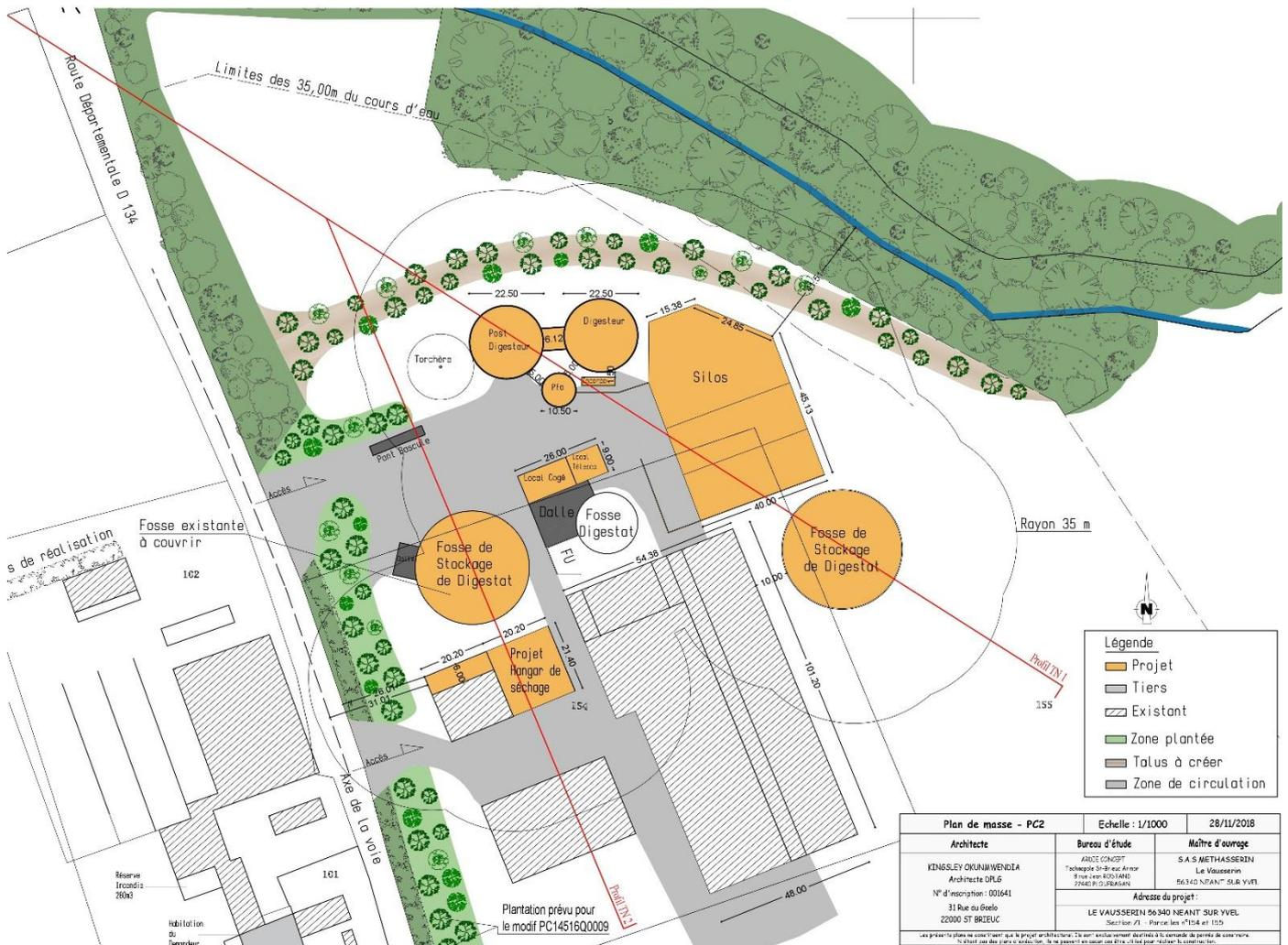
Figure 5 Plan de masse de la future installation de méthanisation
